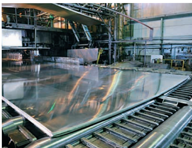
世界最大級の熱間粗圧延機
